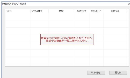
InfoSOSA の接続待ち画面です。USB ケーブル(A-miniB タイプ)で PC と InfoSOSA を接続してください。PC との接続方法は、「[1.6.1 USB ケーブルでの接続](#)」を参照ください。
